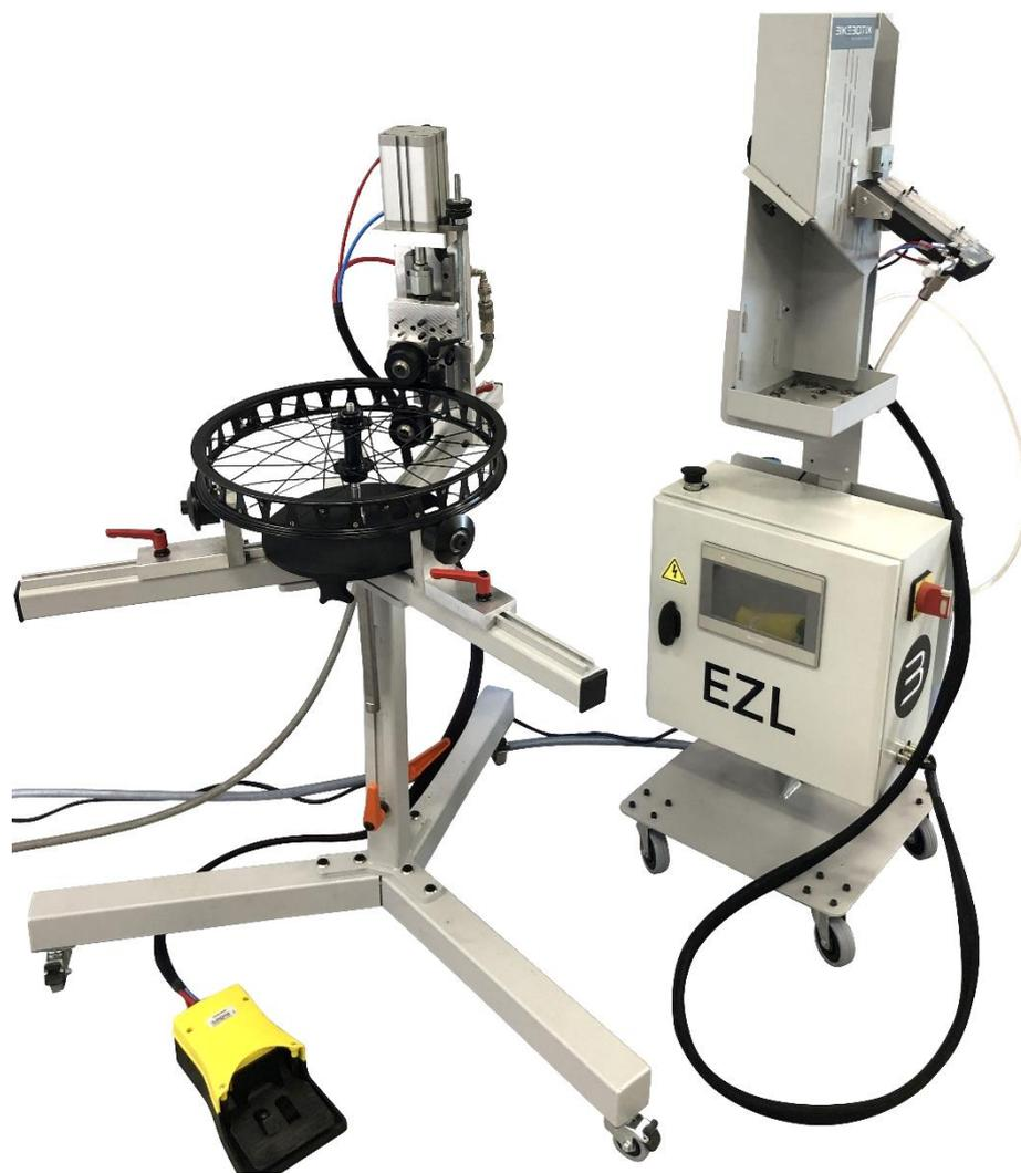
Distributeur d'écrous avec contrôle électronique du vissage pour un rayonnage équilibré de tout type de roues
